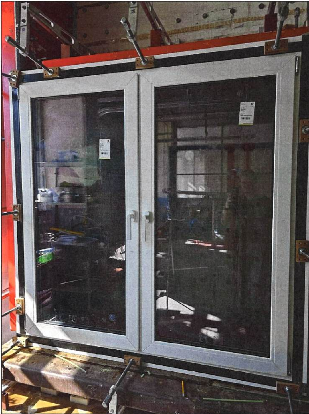
Рисунок 6 – Внешний вид образца 994-24-2-1 в процессе испытаний на водонепроницаемость
