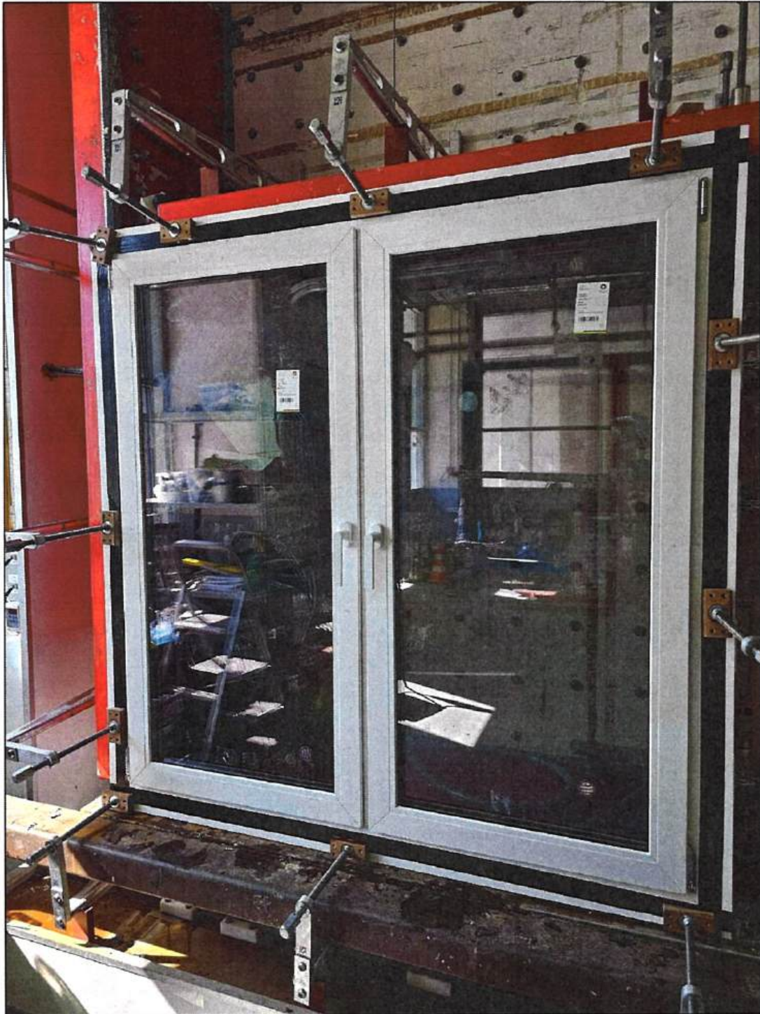
Рисунок 1– Образец 994-24-2-1, установленный на испытательный стенд (на этапе проведения испытаний на воздухопроницаемость)
