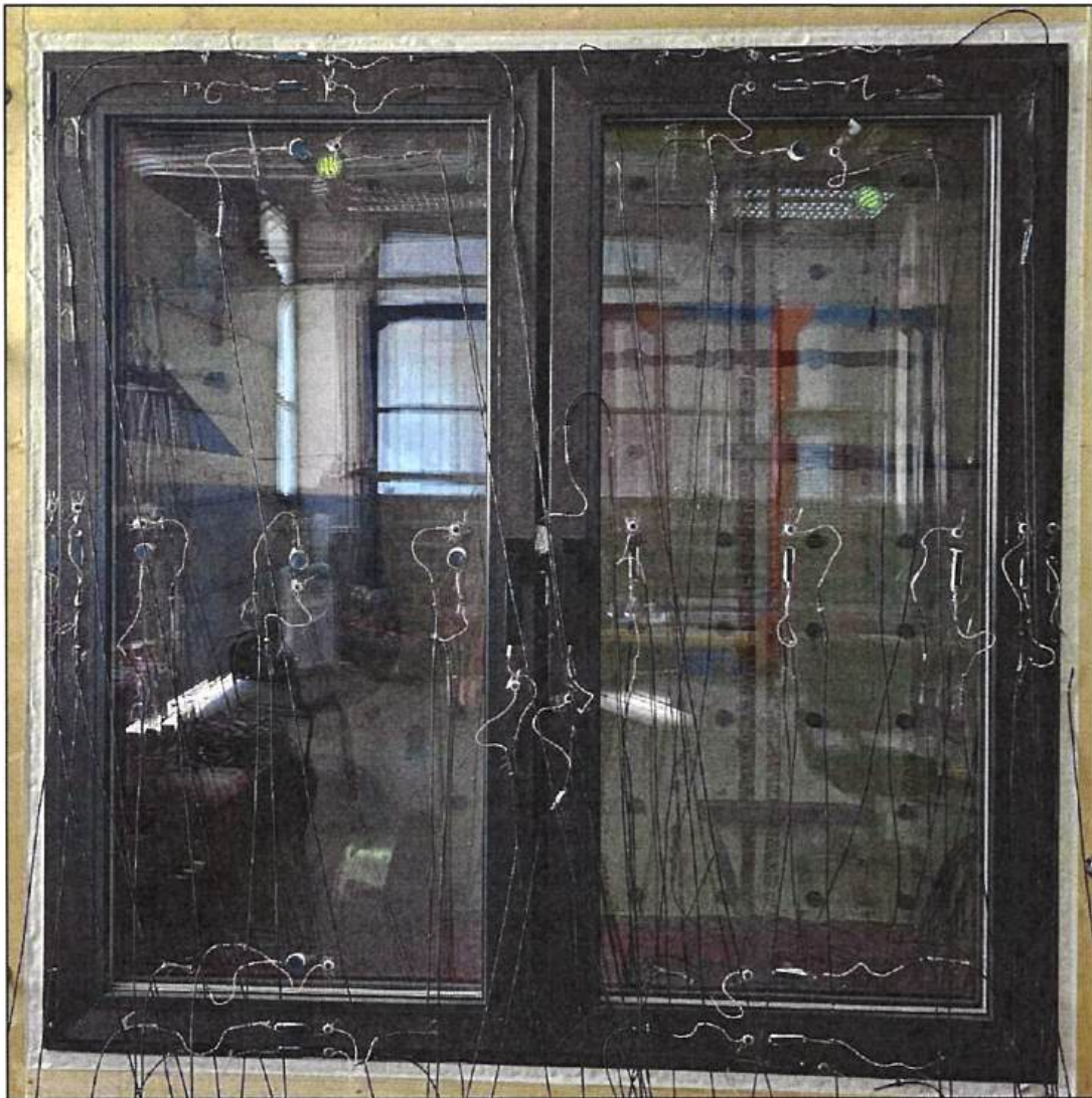
Рисунок 11– Внешний вид образца 994-24-3 в процессе испытаний по определению его приведенного сопротивления теплопередаче
