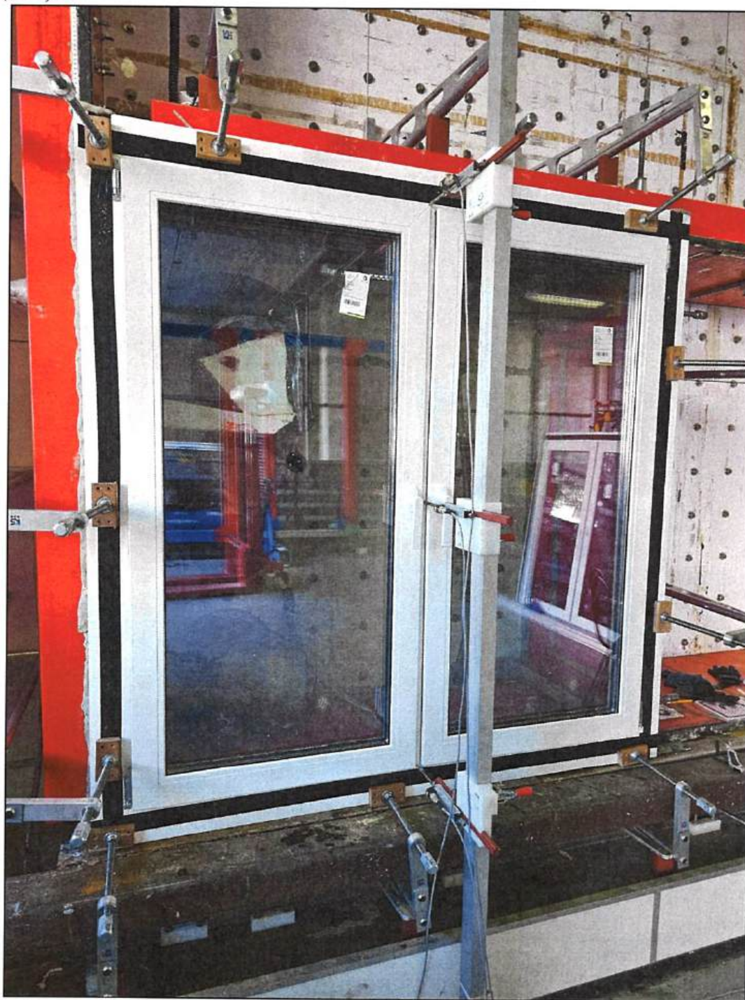
Рисунок 8– Внешний вид образца 994-24-2-2 в процессе испытаний на сопротивление ветровой нагрузке
