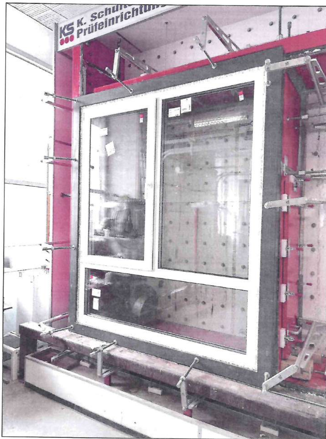
Рисунок 1– Образец 994-24-1, установленный на испытательный стенд (на этапе проведения испытаний на воздухопроницаемость)
